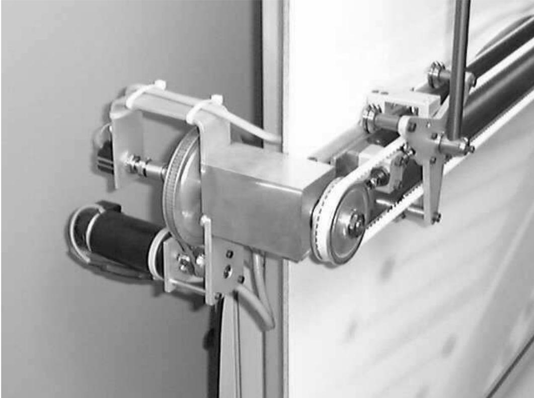
FIG. 4: Vue détaillée de l'entraînement : moteur, réducteur à courroie et chariot
